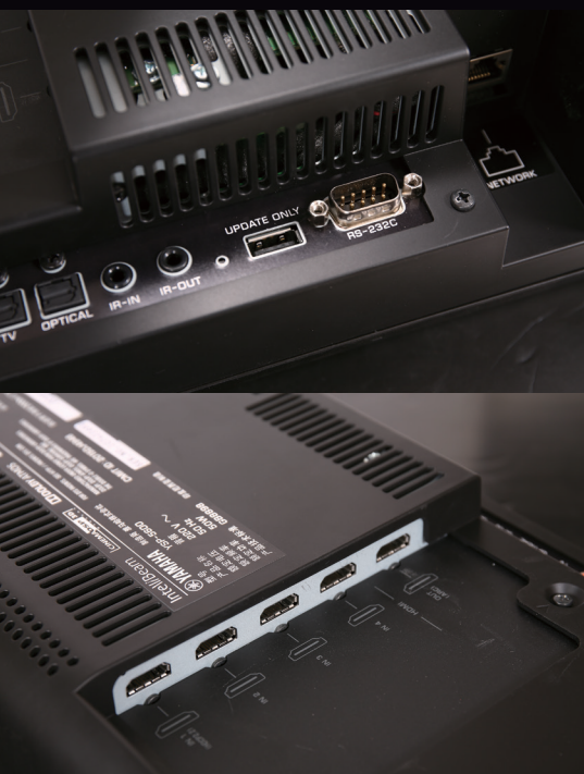
YSP-5600 有 4 组 HDMI 输入，其中 HDMI 1 相容 HDCP2.2 (高带宽数字内容保护技术)、4K/60p (4:2:0) 数字视讯，可以直接输入 4K 蓝光机的信号
